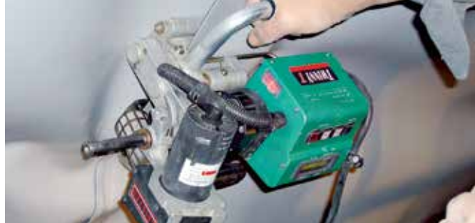
TWINNY T avec poignée transversale pratique pour des soudures en angle au plafond dans un tunnel.
