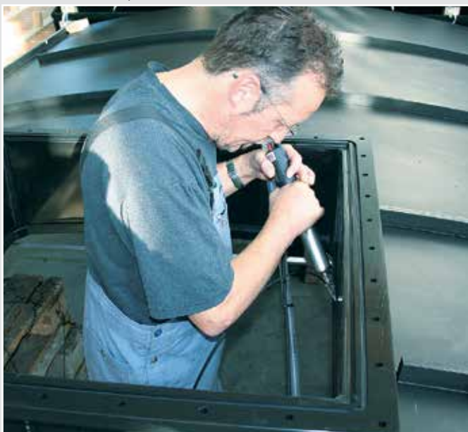
DIODE S en plein soudage en filière sur un détail de réservoir.
