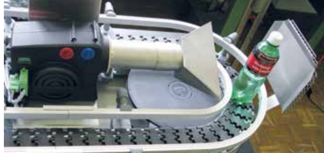
HOTWIND SYSTEM avec buse à fente large intégrée dans une application de soufflage.
